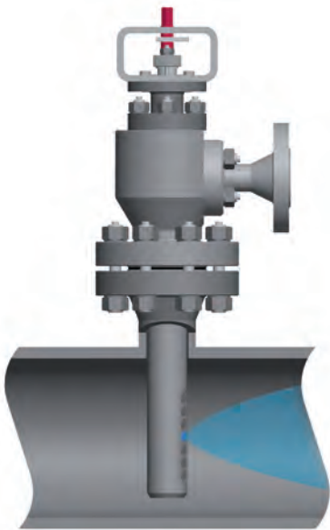
Optimaler Einspritzort: Die erste Düse öffnet in der Mitte der Dampfleitung.
